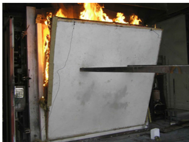
Obrázek 02 Požární odolnost nosné stěny ze slaměných balíků s hliněnými omítkami v rámci projektu MPO Efekt „Vybrané vlastnosti přírodních a dalších stavebních materiálů, stavebních prvků a budov“ (2010) [03]. Figure 02 Fire resistance of load bearing wall from straw bales with clay plasters within the project MPO EFEKT “Selected properties of natural based materials, structural elements and buildings” (2010) [03].
