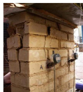
Obrázek 04 Praskliny při porušení sloupu ve střední šířce a střední tloušťce doprovázené dalšími poruchami. Během výzkumu byly testovány různé velikosti stěn, jílové materiály, vazby zdiva a vliv vlhkosti. Obrázek ukazuje sloupek 600/150/900 mm. Figure 04 Pillar breaking cracks at mid-width and mid-thickness accompanied by other faults. Various wall sizes, clay materials, walls bonding pattern and the influence of moisture content were tested during the research. The picture shows pillar 600/150/900mm.
