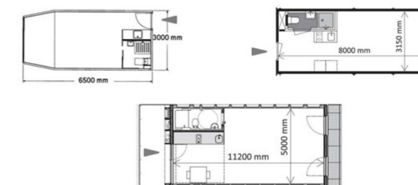
Obrázok 1 Prvý pôdorysný typ modulárnych študentských ubytovacích buniek: charakteristické dispozično-prevádzkové usporiadanie priestorov. Modulárne ubytovacie bunky študentských domovov: Spacebox v Utrechte, DUWO v Delfte a modulárneho internátu v Barcelone. (Zdroje: HOLLAND COMPOSITES. Prefabricated living modules [online]; FRIEDMAN, A. Innovative student residences: new directions in sustainable design, s. 41; GOULA, A. 57 Viviendas Universitarias En El Campus De L'Etsav [online].)
